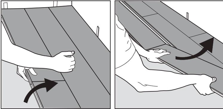
Para separar toda la fila levántela delicadamente en ángulo. Para separar uniones de los extremos de tablonés individuales en una misma fila, déjelos acostados en el piso y deslícelos mientras los separa. Si los tablonés no se separan fácilmente, puede levantar levemente los tablonés (ángulo de 5°) cuando los desliza y los separa.
